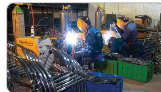
کارخانه راحت آرا قسمت جوشکاری CO2
